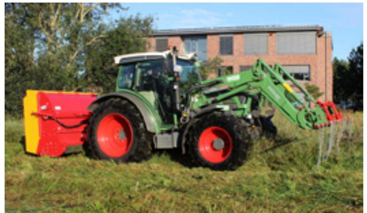
*Vorführung des INO Boxers auf einer Fläche hinter dem Kreis- haus Meppen. Zusätzlich wurde vor den Trecker eine Eisenstange mit Ketten gehangen, die dazu dient die flugfähigen Insekten zu verscheuchen bzw. die Laufkäfer durch die Bewegung abzuwerfen, sodass man über sie drüber mäht ohne dass sie durch diesen Arbeitsschritt verletzt oder getötet werden*
